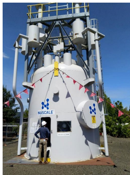
III. 2-5: Illustrations du SMR VOYGR de NuScale. À gauche: coupe transversale (source: NuScale), à droite: modèle grandeur nature (source: Lukas Robers)
