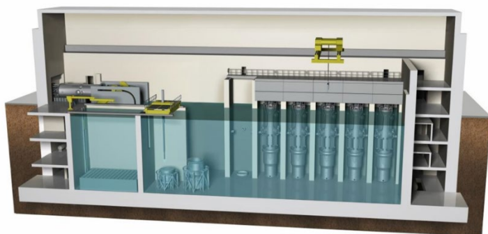
III. 2-5: Illustrations du SMR VOYGR de NuScale. À gauche: coupe transversale (source: NuScale), à droite: modèle grandeur nature (source: Lukas Robers)
